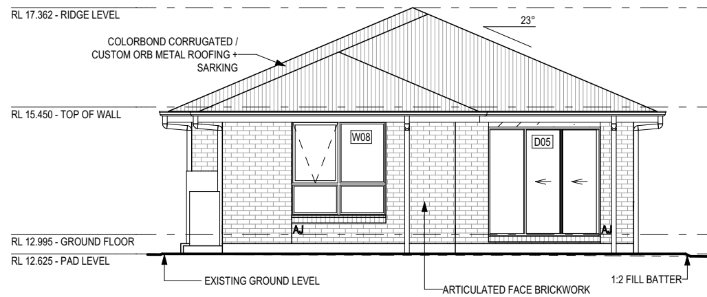
EAST ELEVATION SCALE: 1:100
